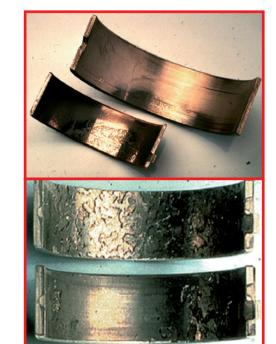
**Síntoma:** Rotura del material de revestimiento mostrando un patrón en la zona de carga principal del coijnete.
