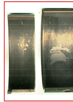
Síntoma: El material de la superficie está dañado localmente. Los puntos defectuosos se ubican simétricos o céntricos en la superficie de deslizamiento del cojinete o detrás del extremo de una ranura de aceite.
