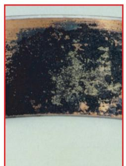
**Síntoma:** Corrosión del material del cojinete. La superficie se desgastará y se decolorará con una apariencia porosa.
