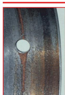
**Síntoma:** Desgaste prematuro del cojinete. Las superficies internas pueden aparecer rayadas y/o tener desechos incrustados. La erosión también puede ser visible junto a una ranura o un orificio de aceite. **Causa:** Aceite lubricante contaminado con material
