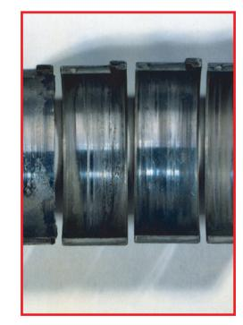
**Síntoma:** Limpieza o fundición de la superficie del cojinete que puede progresar a fatiga y destrucción del
