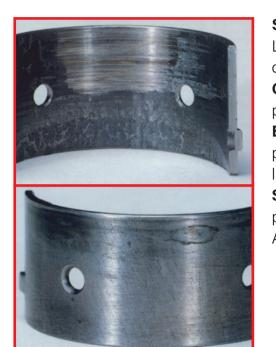
**Síntoma:** Ruptura localizada de la superficie del cojinete. La parte posterior del cojinete estará o marcada abollada detrás del área dañada.
