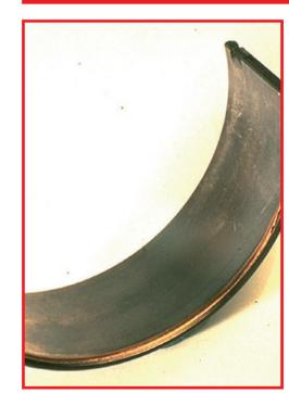
**Síntoma:** La superficie interna del cojinete hace contacto con el borde del cojinete en uno o ambos extremos de la carcasa. El material de revestimiento está desgastado en el/los borde(s) del cojinete a lo largo de su circunferencia.
