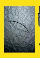
Esta rotura se produce cuando se daña la goma del resorte neumático de los amortiguadores compensadores de carga, produciendo una fisura que provoca una pérdida de aire que deja fuera de servicio el sistema de compensación.
