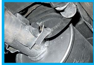
Gomas y soportes de tuberías rotos ó desgastados producen un corte limpio en la soldadura donde la tubería conecta con la carcasa del silenciador. Este fallo es habitual cuando se ha instalado un silenciador nuevo utilizando los viejos soportes o gomas.
