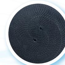
Contaminación química del monolito por el uso de plomo, generalmente proveniente de gasolina con plomo o aditivos antidetonantes no aptos para vehículos con catalizador.
