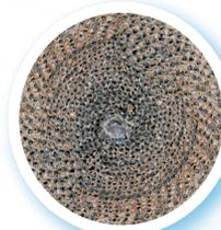
Monolitos obstruidos por depósitos de fósforos. Es el resultado de fallos que llevan al motor a quemar más de 1 litro de aceite por 1.000 km (ej. desgaste de las anillas de los pistones).
