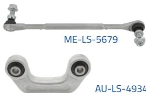
Las barras estabilizadoras en las que los pasadores de bola forman un ángulo de 150° (solo 30° menos que una pieza completamente simétrica) son buenos ejemplos. Los instaladores pueden llegar a invertir fácilmente la posición L (izquierda) / R (derecha), sin tener que aplicar una fuerza anormal durante el montaje. Este error pronto da lugar a golpeteos, que pueden provocar que el pasador de bola se salga de su alojamiento.
