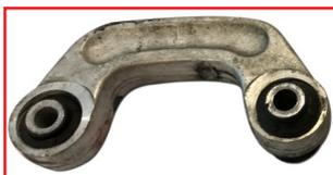
Cualquier accesorio invertido provocará inevitablemente un desgaste prematuro de los bujes.
