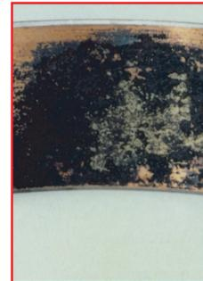
**Symptôme :** Corrosion du matériau du coussinet. La surface est usée et décolorée avec un aspect poreux.
