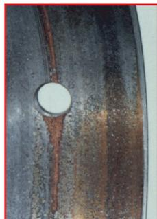
**Symptôme :** Usure prématurée des coussinets. Les surfaces internes peuvent être rayées et/ou comporter des particules d'usure incrustées. L'érosion peut également être visible autour d'une rainure de graissage (patte d'araignée) ou d'un trou de graissage.
