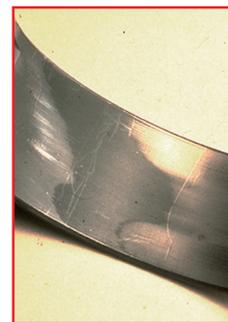
**Symptôme :** Usure du placage uniquement dans la partie plate de la coquille de coussinet vers les bords. Les parties usées sont décalées les unes par rapport aux autres dans la direction circonférentielle.
