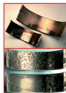
**Symptôme :** Ruptures du matériau de placage montrant un motif similaire à de l'écorce rongée par la scolyte dans la zone la plus chargée du coussinet.
