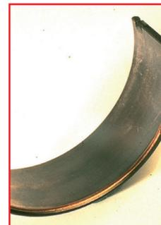
**Symptôme :** La surface intérieure du coussinet touche l'arrondi du tourillon d'un ou des deux côtés de la coquille. Le matériau de placage est usé sur le(s) bord(s) du coussinet sur toute sa circonférence.
