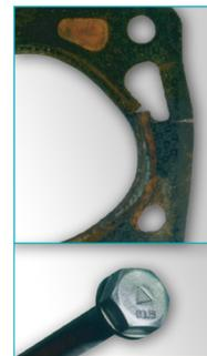
**Síntoma:** Desplazamiento del material de la junta y agrietamiento de los ojales de diámetro debido a la reducción de la fuerza de sujeción. La fuga ocurre dentro de los primeros miles de millas.
