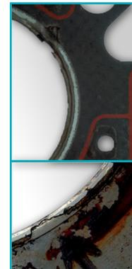
**Síntoma:** El material de la junta se quema, a menudo entre los cilindros, o en un lugar donde se produce detonación o encendido previo. Las decoloraciones indican temperaturas elevadas alrededor de los ojales de diámetro y las vías de fuga de gas de combustión son evidentes.
