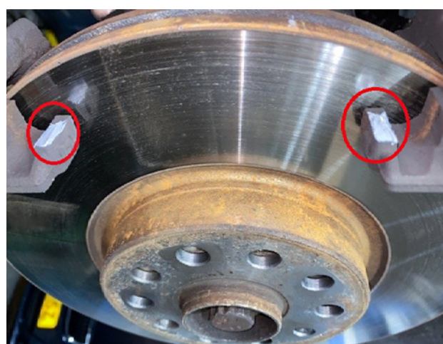
Ruchome części zacisku hamulcowego
