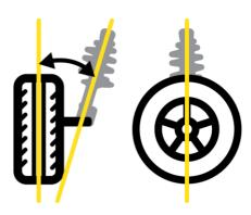
3. По завершении ремонтных работ выполните регулировку схода-развала колес.
