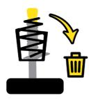
4. Снимите фиксирующую гайку и затем снимите весь узел в сборе.
