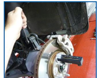
Une fois que le réglage approprié a été obtenu, serrez les boulons inférieur et supérieur aux spécifications suivant la fiche d'instructions fournie.
