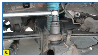
Si nécessaire, serrez l'écrou jusqu'à ce que la goupille fendue puisse être installée. Installez la goupille fendue.
