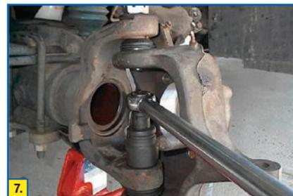
Serrez l'écrou du joint à rotule SUPÉRIEUR à **94 Nm (69 ft. lbs.) SANS UTILISER DE CLÉ À CHOCS**. En effet une telle clé peut vriller le goujon à grande vitesse et causer une panne prématurée (FIG 8).
