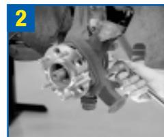
2 Apriete los pernos de montaje del cubo (entre el muñón de la dirección y la brida del módulo) según las especificaciones del fabricante, mediante una llave dinamométrica adecuada.
