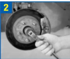
2 Quite la tuerca del eje mediante una llave para tuerca de eje (no se recomienda el uso de una llave de impacto). El tamaño del casquillo puede ir de 30 mm a 36 mm.
