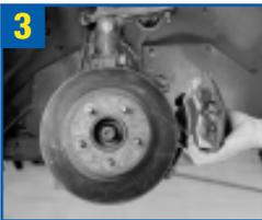
3 Quite y sostenga la mordaza del freno. Asegúrese de que esté posicionada de modo que no interfiera con el procedimiento de instalación. Inspeccione las pastillas de freno.
