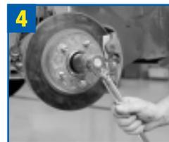
4 Apriete la tuerca del eje según las especificaciones del fabricante. Hágalo con el vehículo levantado y el conjunto de cubo sin carga. Reemplace la tuerca del eje por una nueva. NO use una llave de impacto. Las especificaciones del par de apriete pueden encontrarse en: [www.FMe-cat.com](http://www.FMe-cat.com)
