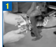
1 Guíe el nuevo módulo por el eje CV al muñón (alinee con cuidado; de lo contrario puede producirse una falla). Antes de finalizar la instalación, conecte el conector del ABS (si existe) y verifique con la llave de encendido en ON que el vehículo esté leyendo una señal correcta proveniente del sensor.
