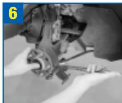
6 Coloque una palanca entre el módulo y el muñón, y sepárelos con cuidado.
