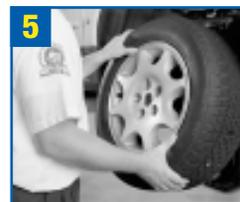
5 Vuelva a colocar la rueda neumático en el vehículo. Baje el vehículo hasta el suelo y apriete las tuercas de rueda según la especificación, mediante una llave dinamométrica.
