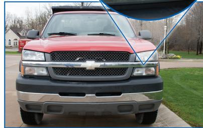
El GMT 900 ('Nuevo') tiene un conjunto de faro delantero de una pieza.
