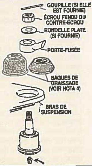
Cette pièce peut être dotée d'un indicateur d'usure. Cet indicateur sert à déterminer le moment de remplacer la rotule par inspection visuelle. Il est utilisé aux mêmes fins que l'indicateur de non-usure. L'un ou l'autre indicateur fonctionnera bien dans le véhicule.
