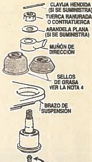
Esta pieza puede incluir un indicador de desgaste que se usa para determinar cuando se deba de cambiar la articulación de rotula al hacer una inspección visual. Proporcione al el servicio a las mismas aplicaciones como el tipo de indicador equivalente que no se señala el desgaste. Cualquier de las unidades desempeñará por igual sus funciones correctamente en el vehículo.
