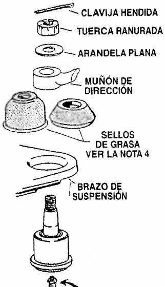
Esta pieza puede incluir un indicador de desgaste que se usa para determinar cuando se deba de cambiar la articulación de rótula al hacer una inspección visual. Proporciona el servicio a las mismas aplicaciones como el tipo de indicador equivalente que no señala el desgaste. Cualquiera de las unidades desempeñará por igual sus funciones correctamente en el vehículo.
