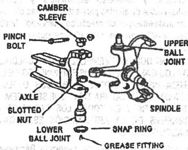
12. Installer le manchon de réglage de carrossage sur le goujon du joint à rotule supérieur dans le sens approprié et le frapper doucement pour le mettre en place. Serrer l'écrou du joint à rotule inférieur à 110-140 lb-pi (149-190 N-m).
