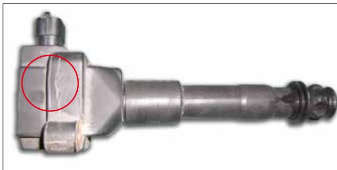
Formación de grietas longitudinales en el cuerpo de la bobina debido a un par de apriete incorrecto y excesivo de 15 N·m en lugar del valor correcto de 6 N·m.
