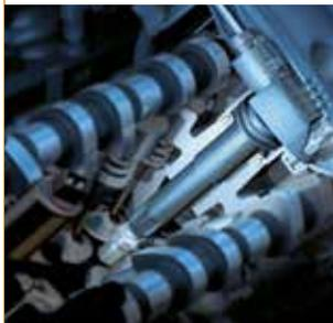
Las bobinas de encendido con receptáculo están montadas al fondo del compartimiento del motor y deben soportar cargas térmicas extremas.
