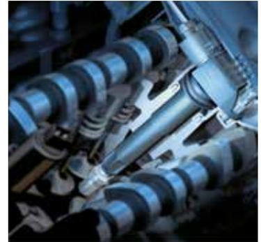
Las bobinas de encendido con receptáculo están montadas en el fondo del compartimiento del motor y deben soportar cargas térmicas extremas.
