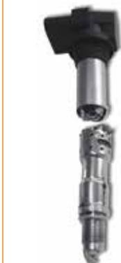
Solo se tendría que haber cambiado la bujía de encendido; sin embargo, debido al uso de una herramienta de extracción incorrecta, ahora también es necesario cambiar la bobina.
