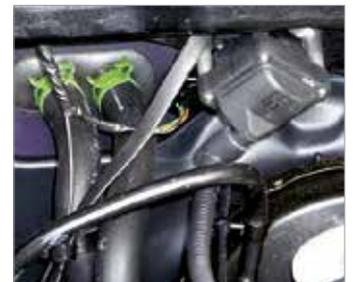
Las bobinas de encendido que se montan directamente sobre el tabique divisorio están especialmente expuestas. La consecuencia posible es la oxidación de los contactos.
