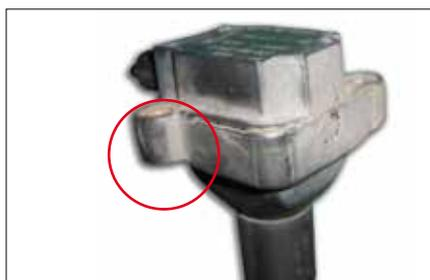
Formación de grietas en el aislante de la bobina de encendido debido a tensiones durante la instalación.
