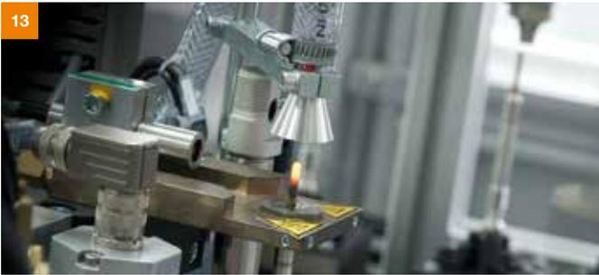
Tests de funcionamiento del PSG completamente funcionales: el test de incandescencia demuestra que el calentador alcanza la temperatura necesaria en el tiempo asignado.
