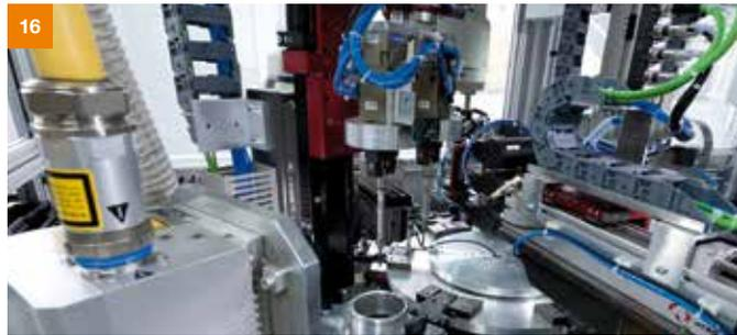
Únicamente los calentadores que han superado todos los tests pasan a la etapa siguiente, el marcado por láser.
