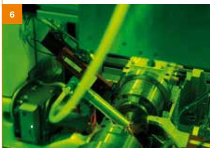
A continuación, se monta el conector de alimentación del calentador y se suelda en el terminal interior.
