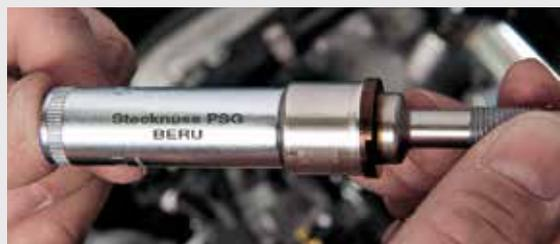
Instalación y eliminación segura de los calentadores PSG con el conjunto de brocas de BERU, de un tamaño 12 de ancho (nº artículo de BERU 089000006).
