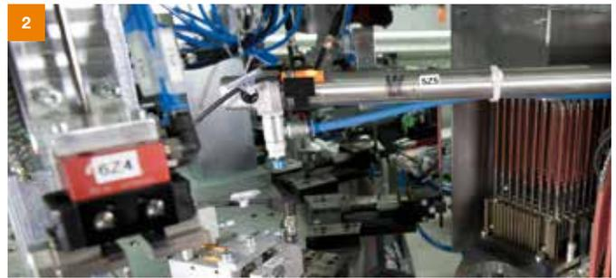
Inicio del proceso de fabricación totalmente automatizado: montaje del elemento de calentamiento y su extensión...
