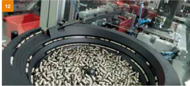
Para conseguir que el cojinete del vástago de calentamiento sea flexible, el tubo del calentador se recubre con una envoltura. En la figura se muestra el avance de la envoltura a través de un carril transportador.
