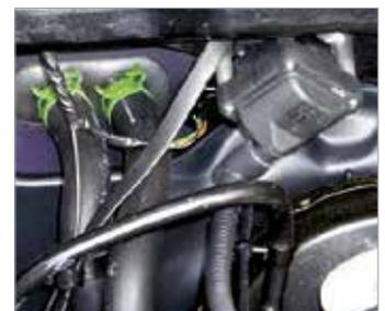
Les bobines d'allumage montées directement contre la paroi de projection sont particulièrement exposées à ces sollicitations. Conséquence possible : oxydation des contacts.
