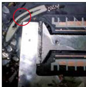
**Imitation** : le câble de haute tension et le noyau en fer doivent présenter une distance de sécurité par rapport à la haute tension. Ici, le câble de haute tension est trop près du noyau en fer. Conséquences possibles : claquages haute tension et panne totale de la bobine d'allumage.
