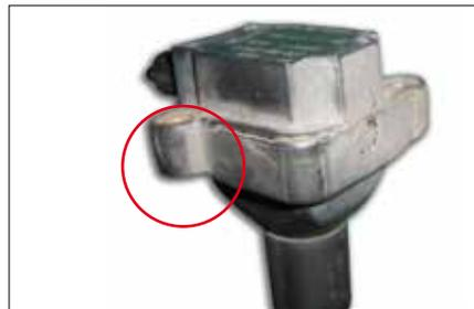
Formation d'une fissure sur l'isolation de la bobine d'allumage due à une torsion lors du montage.
