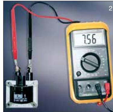
Valeurs de contrôle bobine d'allumage ZS 283 montée p. ex. dans la Fiat Punto, Panda ou Tipo. Remarque : la bobine d'allumage et l'étage final de puissance sont ici un seul et même composant et ne peuvent pas être remplacés séparément.
