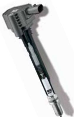
Système d'allumage BERU, peu encombrant et très efficace: bougie double platine avec bobine d'allumage Plug-Top. Le connecteur à ressort de pression interne sur la nouvelle bougie d'allumage double platine empêche les contournements d'isolateurs.
