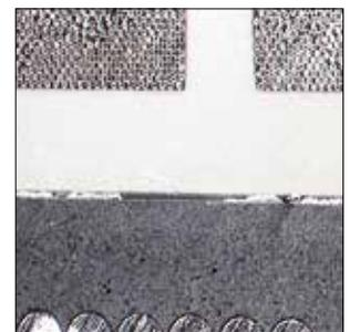
**Imitation** : détachement entre le corps de la bobine primaire et le corps de la bobine secondaire dû à un appariement imparfait des matériaux. Cela peut conduire à des courants de fuite et des claquages vers la bobine primaire et à la panne de la bobine d'allumage.
