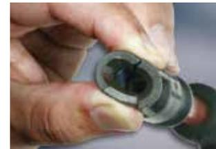
Les microfissures sont bien visibles lorsque l'on compresse le connecteur de bougie.
