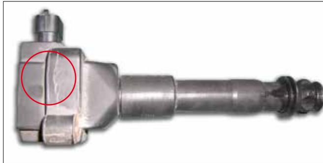
Formation d'une fissure longitudinale sur le corps de la bobine due à un couple de serrage incorrect de 15 Nm au lieu de 6 Nm.
