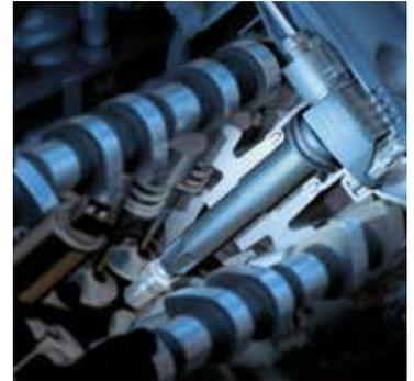
Les bobines crayon se trouvent au fond du compartiment moteur et doivent résister à des sollicitations thermiques extrêmes.
