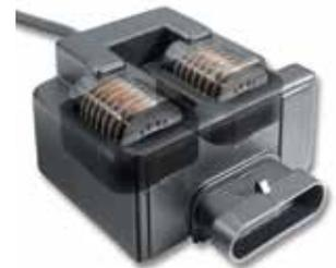
Comparé aux bobines conventionnelles, la nouvelle technologie de bobines d'allumage de BERU offre un retard d'allumage beaucoup plus court et une meilleure stabilité de combustion sur toute la durée de combustion, principalement dans la plage de charge partielle et au ralenti. L'électronique intégrée permet le chargement et le déchargement successifs des bobines ainsi que la variation de l'énergie d'allumage. Avantages : consommation minimale d'énergie pendant tout le fonctionnement.
