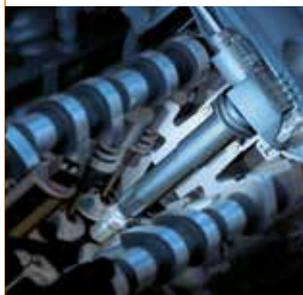
Les bobines d'allumage crayon se trouvent au fond du puits de bougie et doivent résister à des sollicitations thermiques extrêmes.
