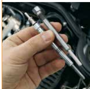
L'alesatore BERU - (RA003 - 0 890 100 003) asporta le incrostazioni che possono crearsi dopo la "cottura" tra candela e testata.
