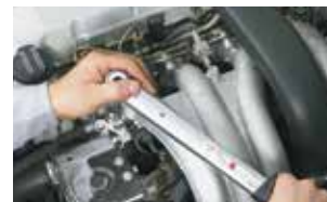
Per rimuovere e inserire le candele utilizzare UNICAMENTE una chiave dinamometrica.
