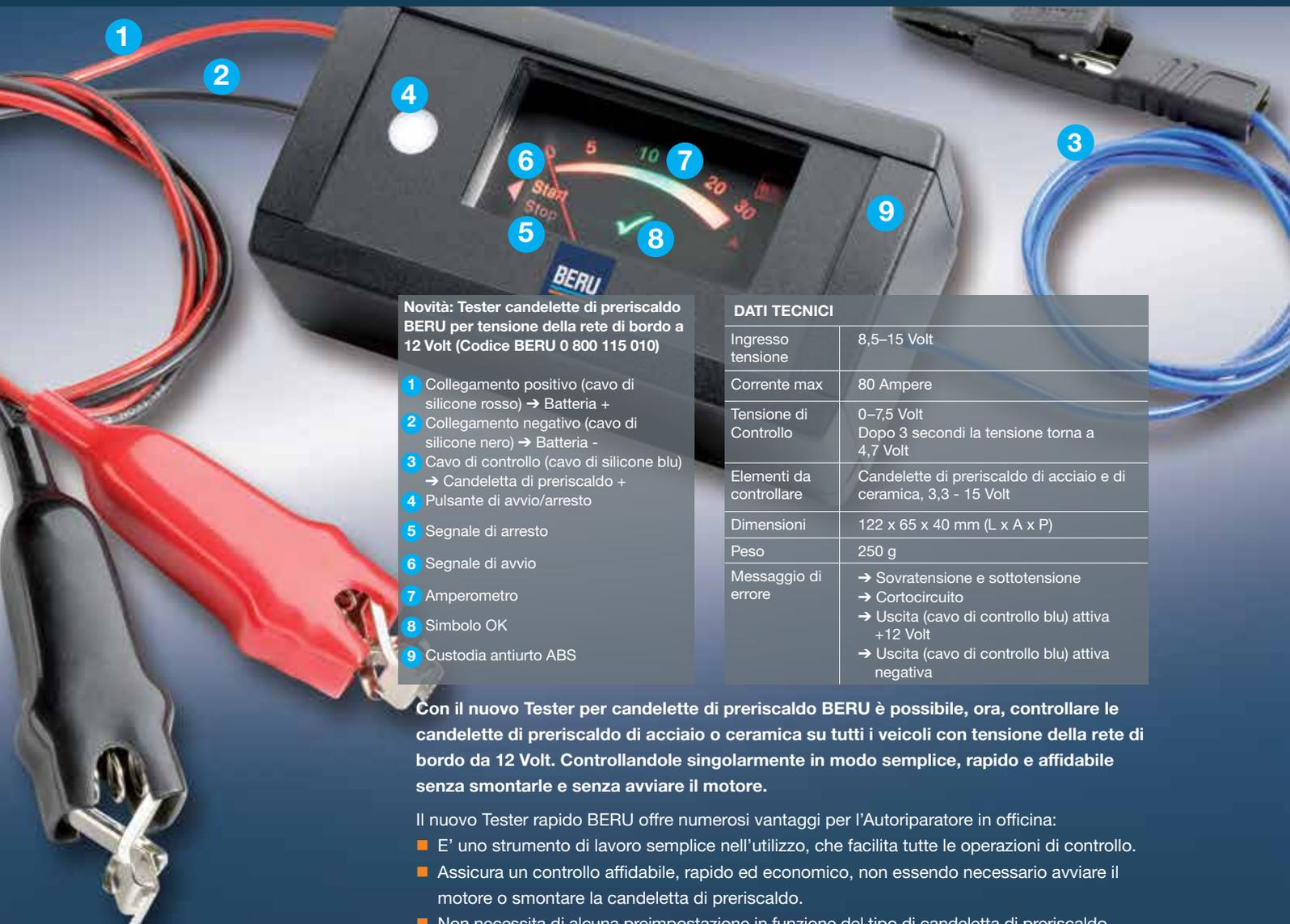
Novità: Tester candele di preriscaldamento BERU per tensione della rete di bordo a 12 Volt (Codice BERU 0 800 115 010)
