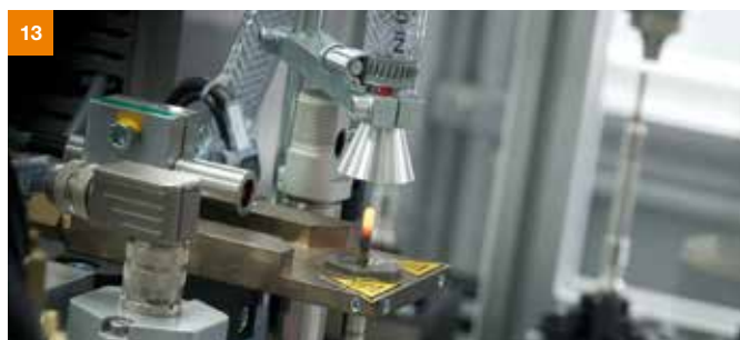
Prova funzionale eseguita sul 100% delle candeledda PSG: la prova verifica se la candeledda raggiunge la temperatura richiesta nel tempo stabilito.
