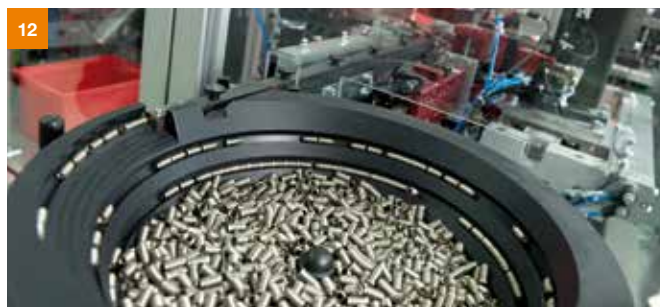
Al fine di rendere il riscaldatore flessibile, il tubo della candeledda viene circondato da una cuffia. L'immagine mostra l'alimentazione di queste cuffie mediante un convogliatore.
