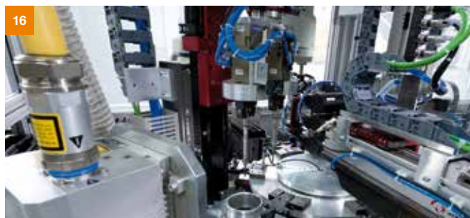
Solo le candeledda che hanno superato tutte le prove vengono trasportate nell'area predisposta per il passaggio successivo: la marcatura laser.
