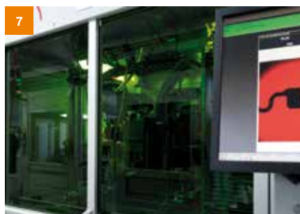
Questa fase del processo di produzione viene monitorata da un sistema a rilevamento visioni elettronico.
