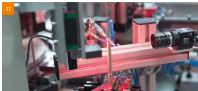
L'alimentazione della parte superiore della candeledda viene monitorata e documentata da una telecamera.
