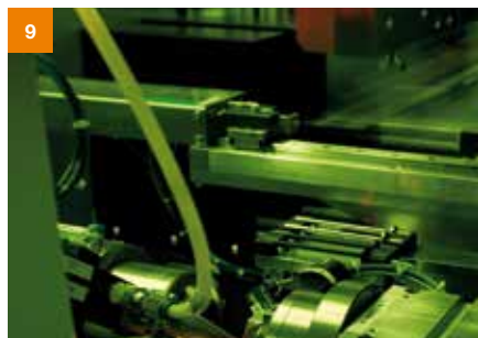
Nel 6° modulo il sensore viene saldato al laser sulla prolunga.
