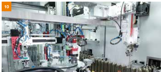
Nel modulo della logistica, i componenti vengono trasferiti dal primo al secondo treno di produzione, dove avviene il pre-montaggio del cappuccio.
