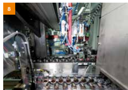
Il connettore di corrente della candela viene alimentato attraverso il condotto all'interno del modulo del sensore.
