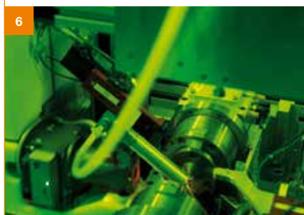
Poi il connettore di potenza della candela viene montato e saldato sul terminale interno.
