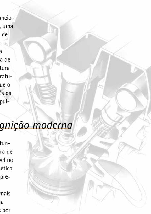
Durante o ciclo de compressão, a faísca da vela de ignição dá início à combustão da mistura comprimida de combustível e ar.
