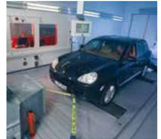
As propriedades de arranque a frio das velas de ignição são testadas no suporte do ensaio móvel de dois eixos no Centro de Investigação e Desenvolvimento Ludwigsburg da BERU.
