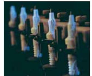
Teste de isoladores com 40.000 Volt: as velas de ignição Beru têm de provar sua fiabilidade nos dinamómetros antes de começarem a ser produzidas em série.
