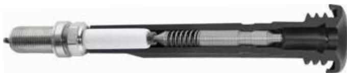
Maior resistência à descarga disruptiva, apesar de maior tensão de ignição: graças ao pescoço isolador mais longo, à maior sobreposição, à mola de pressão encastrada e à nova tecnologia de contacto.
