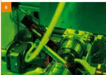
Em seguida, o conector de alimentação de incandescência é montado e soldado no terminal interno.
