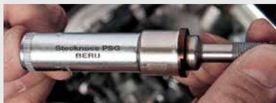
Remoção e instalação seguras das velas de incandescência PSG com o conjunto de chaves da BERU, tamanho 12 de distância entre fases (BERU, artigo n.º 0890000006).
