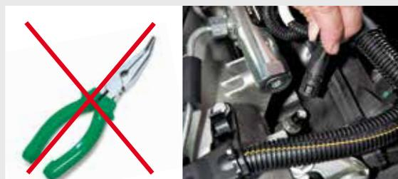
Quando soltar o conector da PSG da BERU, é importante: fazê-lo manualmente e não utilizar ferramentas como alicates ou algo semelhante!
