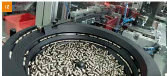
Para alcançar o rolamento flexível da barra de aquecimento, o tubo de incandescência é rodeado por um fole. A figura mostra a alimentação do fole através de um trilho de transporte.
