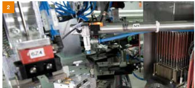
Início do processo de produção totalmente automatizado: A instalação do elemento de aquecimento e a sua extensão...
