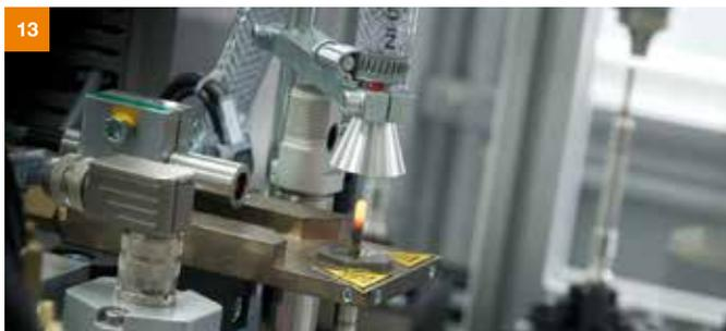
Teste 100% funcional da PSG: O teste de incandescência prova que a vela alcança a temperatura necessária no tempo atribuído.
