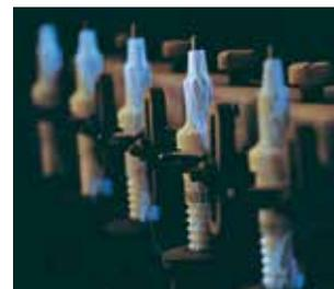
Проверка изоляторов при 40 000 В: свечи зажигания BERU должны продемонстрировать надежность на испытательной установке, и только затем они пойдут в массовое производство.
