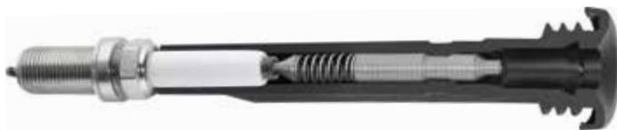
Увеличенное сопротивление пробоя несмотря на возросшую мощность зажигания: благодаря более длинной шейке изолятора, встроенной нажимной пружине и новой технологии соединения.
