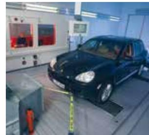
Свойства свечи зажигания при холодном пуске проверяются на двухосном мобильном испытательном стенде в научно-техническом центре BERU в Людвигсбурге.
