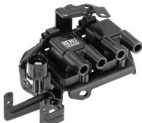
Zündspule Anschlußausführung DIN
