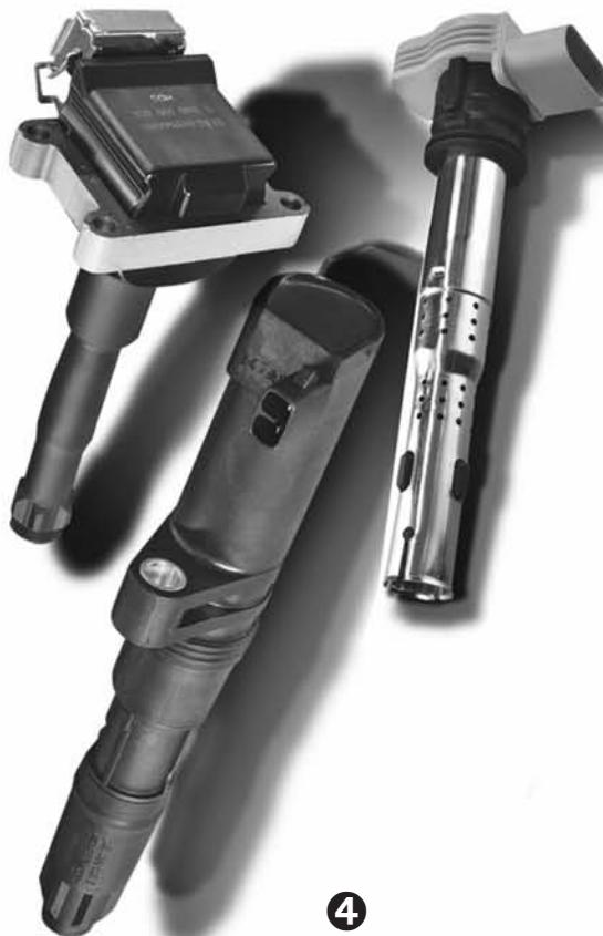
Differenti esecuzioni di bobine di accensione per pozzetto candela e a spinotto per modelli di vetture di BMW, Fiat, Mercedes-Benz, Porsche, Renault o VW.
