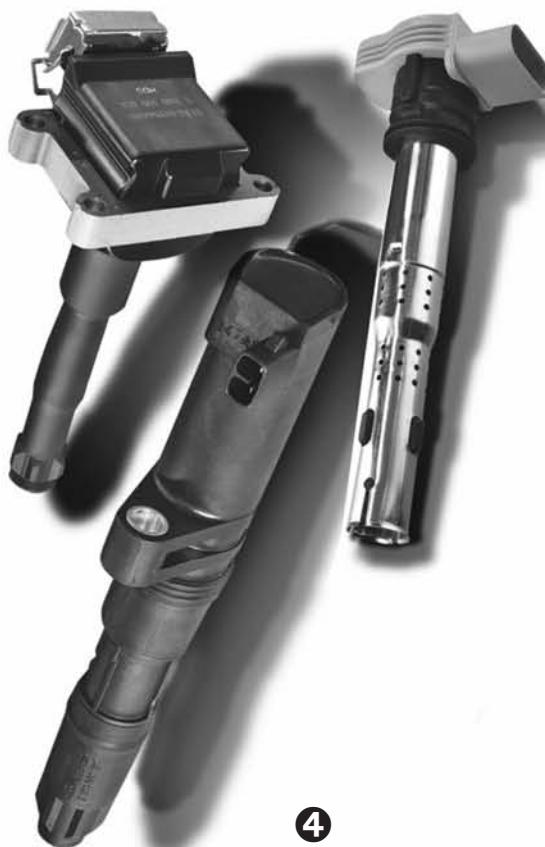
**Unterschiedliche Ausführungen von Kerzenschacht-/Steckerzündspulen für Fahrzeugmodelle von BMW, Fiat, Mercedes-Benz, Porsche, Renault oder VW.**
