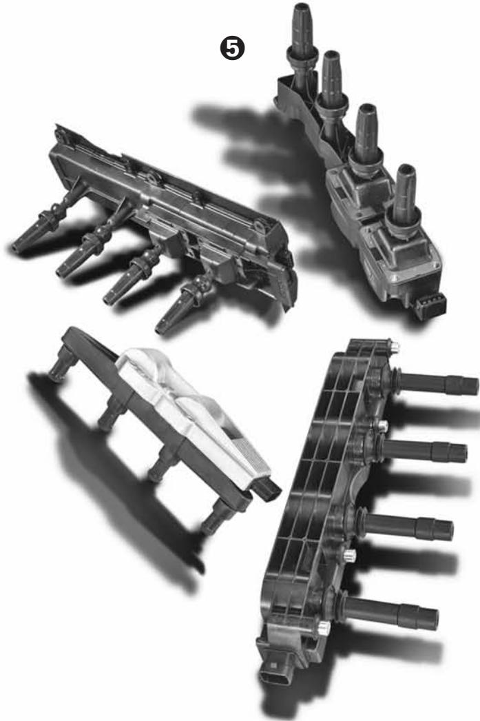
Einbau von Original BERU Markenzündspulen: Denn diese bieten durch die trockene und damit auslaufsichere Isolierung zwischen Spulenwicklung und Bechergehäuse deutlich mehr Sicherheit. Die von Billiganbietern gefertigten Becherzündspulen sind oftmals mit Öl gefüllt – das bei einem Defekt oder Unfall auslaufen und zu einem Fahrzeugbrand führen kann.
