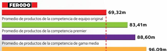
Se roció agua directamente en el disco de freno, así como en la superficie de la carretera, para crear las condiciones húmedas más realistas en todas las configuraciones de frenos. Cada producto se probó con seis frenadas de 80 km/h a 0 km/h.
