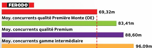
De l'eau est directement pulvérisée sur le disque de frein et sur la route, pour créer les conditions d'humidité les plus réalistes qui soient pour chaque réglage de frein. Chaque produit a été testé lors de 6 sessions de freinage de 80 à 0 km/h.
