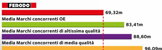
L'acqua è stata spruzzata direttamente sul disco freno e sul manto stradale per creare le condizioni più realistiche possibili e costanti per ogni prova. Ogni prodotto è stato testato mediante 6 frenate da 80 a 0 km/h.
