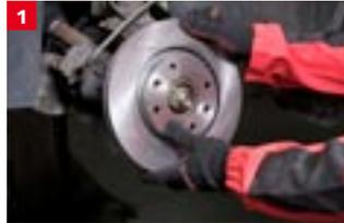
**BESCHREIBUNG** Ein tiefes Geräusch mit einer Frequenz unter 300 Hz. Dies wird normalerweise von Makrovibrationen einer Bremssystemkomponente, z.B. der Bremsscheibe, verursacht
