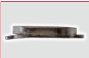
**AUSSEHEN** Trägerplatte beschädigt
