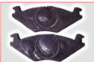
**AUSSEHEN** Anti-Geräusch-Vorrichtungen (Gummibeschichtung / Shim) vom Kolben beschädigt
