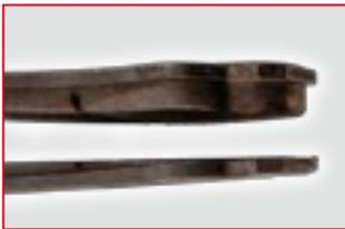
**AUSSEHEN** Ein Bremsbelag oder mehrere Beläge im Achsensatz sind übermäßig verschlissen
