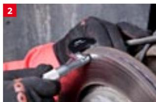
**DESCRIZIONE** Rumore con frequenza compresa tra 300 - 5.000 Hz. Solitamente è originato da micro-vibrazioni nel pistoncino della pinza o in un'altra parte del sistema freno/sospensione del veicolo.
