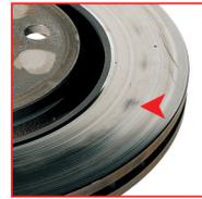
**AUSSEHEN** Ungleichmäßiger Verschleiß der Bremsflächen. Blaue Flecken in der Mitte der Bremsfläche. Mögliches Auftreten von Rissen
