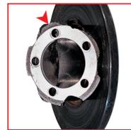
**AUSSEHEN** Nabenkontaktfläche gelöst oder verformt
