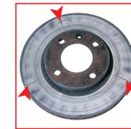
**AUSSEHEN** Radiale Risse/blau Flecken auf Höhe der Entlüftungsöffnungen
