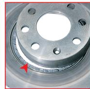
**AUSSEHEN** Ablösen des Bremsscheibentopfs von der Bremsfläche
