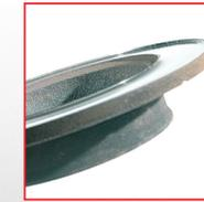
**AUSSEHEN** Übermäßiger Verschleiß. Die Dicke der Bremscheibe liegt unter der vom Hersteller empfohlenen Mindestdicke
