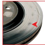
**SÍNTOMA** Desgaste desigual de las superficies de frenado. Manchas azules en el centro de la superficie de frenado. Posible existencia de grietas
