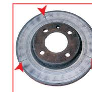
**SÍNTOMA** Fracturas radiales o manchas azules correspondientes a los orificios de ventilación
