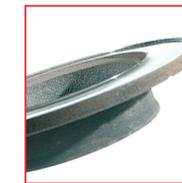
**SÍNTOMA** Desgaste excesivo. El espesor del disco es menor que el mínimo recomendado por el fabricante (MIN TH)
