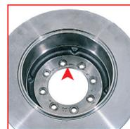
**SÍNTOMA** Superficie de contacto con el buje deformada o aparición de grietas alrededor de los orificios de fijación
