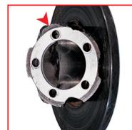
**SÍNTOMA** Desprendimiento o deformación de la superficie de apoyo del disco con el buje
