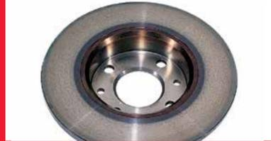
**Cause :** Mauvais rodage. Encas de mauvais rodage, les surfaces de friction surchauffent. Cela entraîne une transformation métallurgique de la surface du disque.
