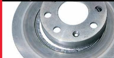
**Cause :** Contrainte mécanique causée par un mauvais alignement et mauvais montage/ positionnement de l'étrier et du disque. Elle provoque une usure asymétrique de la surface de freinage.
