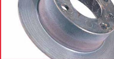
**Cause :** Une usure excessive ou totale des plaquettes de frein entraîne un contact entre la plaque d'appui dans l'étrier. Dans ce cas, la plaque d'appui de la plaquette usée se désolidarise de son siège dans l'étrier et entraîne la formation de rayures entre le plateau et la surface du disque.
