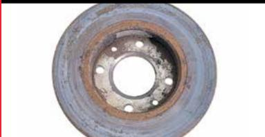
**Cause :** Dépôts de matériau de friction sur la surface du disque. Cela apparaît généralement si des plaquettes de frein de mauvaise qualité ont été montées.
