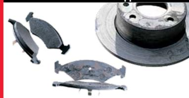
**Cause :** Une plaquette de frein constamment en contact avec le disque. Cela provoque l'usure de la plaquette jusqu'à la plaque d'appui métallique.
