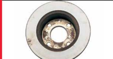
**Cause :** Contamination de la surface du moyeu. Elle entraîne un décalage pendant le montage et un contact irrégulier entre la surface du disque et des plaquettes, ainsi qu'une usure irrégulière du disque.
