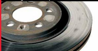
**Cause :** Un montage incorrect de l'étrier et/ou des plaquettes peut faire que les plaquettes aient des angles différents par rapport au disque, chaque côté s'usant à des vitesses différentes. Les taches bleues sont dues à une importante surchauffe localisée.
