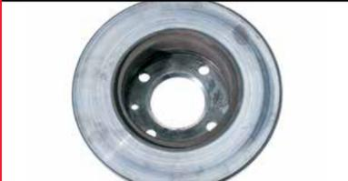
**Cause :** Voile excessif du moyeu et un contact irrégulier entre le disque et les plaquettes qui produit des vibrations provoquant une surchauffe localisée.
