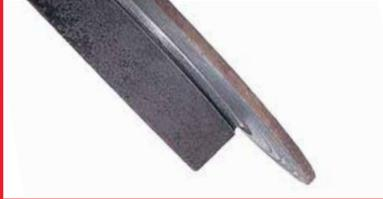
**Cause :** Une usure extrême des plaquettes et des disques peut entraîner le déplacement de la plaque d'appui dans l'étrier. Dans ce cas, la plaque d'appui de la plaquette usée se désolidarise de son siège dans l'étrier et entraîne la formation de rayures entre le plateau et la surface du disque.
