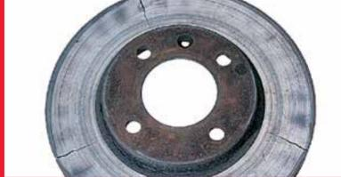
**Cause :** Les taches bleues sont dues à des fissures croissantes causées par une transformation métallurgique à la surface du matériau, en le rendant dur et cassant. Ceci est courant pour les freins surchargés au-delà des limites normales de conception. Cela peut découler d'une conduite agressive, d'une charge excessive ou d'un usage intensif ou non habituel du frein.
