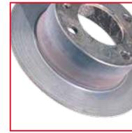
**ВНЕШНИЙ ВИД** Значительный износ дисков с появлением канавок на поверхности
