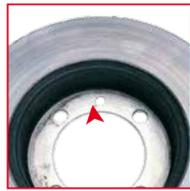
**ВНЕШНИЙ ВИД** Искривление поверхности соприкосновения со ступицей и/или появление трещин вокруг нее
