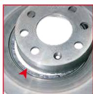
**ВНЕШНИЙ ВИД** Разрушение диска – отхождение шляпки диска от рабочей поверхности тормозов
