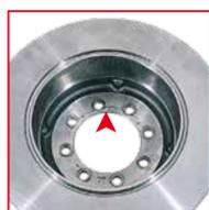
**ВНЕШНИЙ ВИД** Искривление поверхности соприкосновения со ступицей и/или появление трещин вокруг посадочных отверстий
