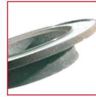
**ВНЕШНИЙ ВИД** Чрезмерный износ. Толщина дисков меньше минимальной толщины, рекомендованной производителем
