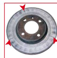
**ВНЕШНИЙ ВИД** Радиальные трещины/синие пятна, соответствующие вентиляционным рамкам
