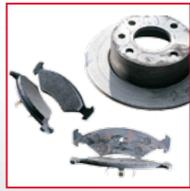
**ВНЕШНИЙ ВИД** Неравномерный износ тормозных колодок. Значительный износ одной колодки при минимальном износе колодки на противоположной стороне
