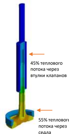
Полый клапан с натриевым наполнителем
