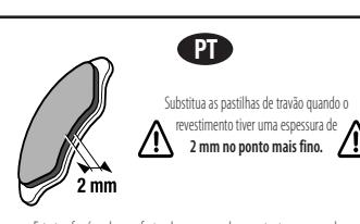
PT Substitua as pastilhas de travão quando o revestimento tiver uma espessura de 2 mm no ponto mais fino.
