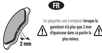
FR Les plaquettes sont à remplacer lorsque la garniture n'a plus que 2 mm d'épaisseur dans sa partie la plus mince.
