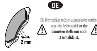
DE Die Bremsbeläge müssen ausgetauscht werden, wenn das Reibmaterial an der dünnsten Stelle nur noch 2 mm dick ist.
