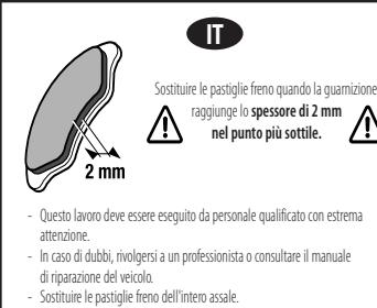
IT Sostituire le pastiglie freno quando la guarnizione raggiunge lo spessore di 2 mm nel punto più sottile.
