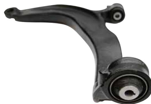
MOOG ofrece el VO-WP-2316/2317 únicamente con el silentblock de carga pesada colocado.
