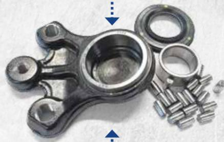
DAS UNTERE KUGELGELENK DIENT ALS DREHPUNKT, DER EINE AXIALE DREHUNG ERMÖGLICHT.
