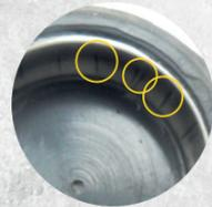
Los daños pueden ser causados durante el prensado debido al contacto de metal con metal, altamente sensible a una instalación incorrecta.
