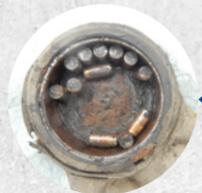
Risque de mauvaise étanchéité pouvant provoquer de la corrosion et une détérioration prématurée.
