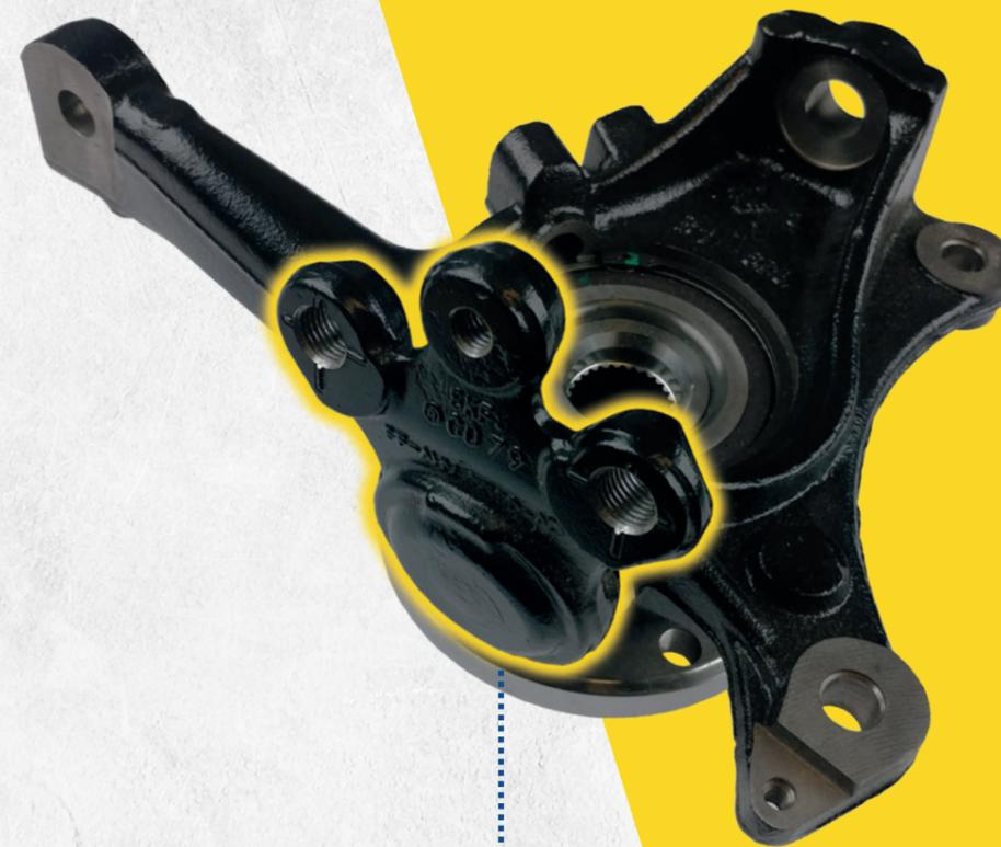
LA ROTULE INFÉRIEURE AGIT COMME UN PIVOT PERMETTANT UNE ROTATION AXIALE.
