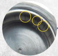
Des dommages peuvent être causés par le processus de pressage en raison du contact métal sur métal, risque d'une installation incorrecte.
