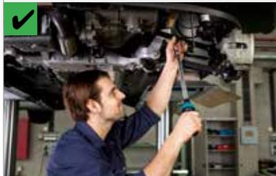
Utilisez une clé dynamométrique, c'est la seule méthode pour serrer correctement la pièce.
