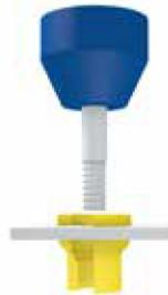
4. Выверните инструмент из резьбовой вставки рычага подвески. Резьбовая вставка установлена. Установите датчик высоты корректора ксеноновых фар.
