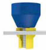
3. С помощью этого инструмента установите резьбовую вставку до конца на место
