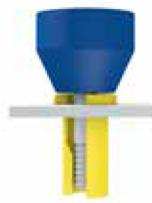
2. Запрессуйте резьбовую вставку с помощью вкрученного в нее инструмента в предназначенное для вставки отверстие в треугольном рычаге подвески.
