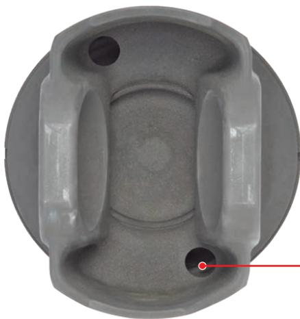
La galería cerrada del pistón es única y esta manufacturada a través de un proceso patentado de soldadura por fricción; ganador de premios a nivel mundial; que controla con precisión el desplazamiento de metal y estructura de grano que combina dos mitades de componentes independientes en un pistón de una pieza de excepcional resistencia estructural.
