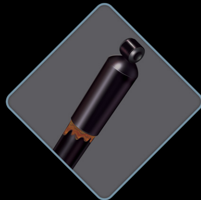
Si presenta fugas Reemplazar
