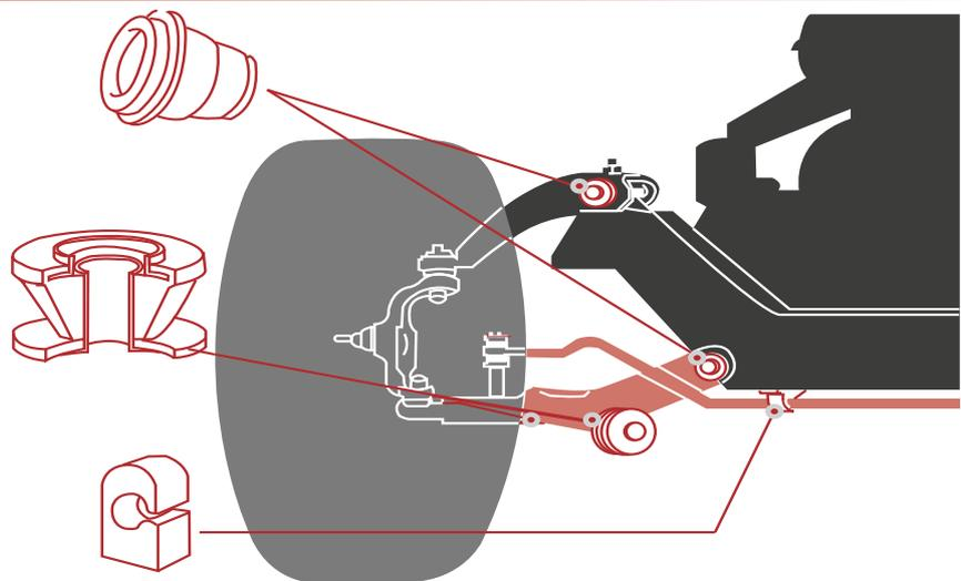
**TS ofrece una amplia cobertura de bujes para horquillas, tirantes y barras estabilizadoras.**
